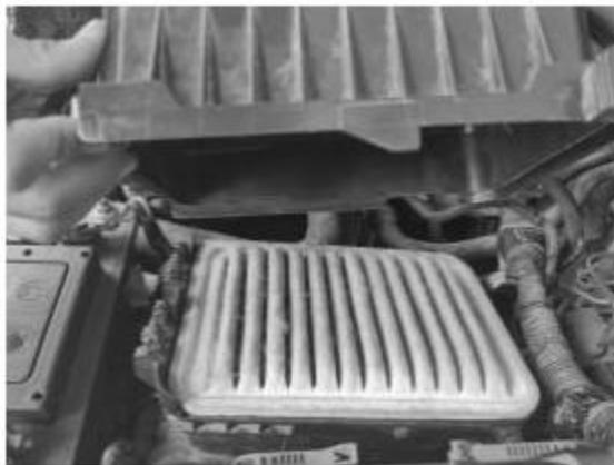
图 2-1-26 取出空气滤清器的滤芯
