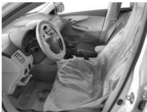
图 1-1-6 安装三件套
