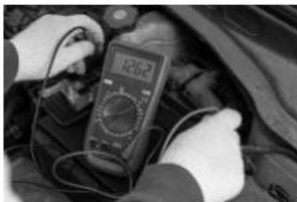
图 2-3-4 蓄电池充电电压的检测
