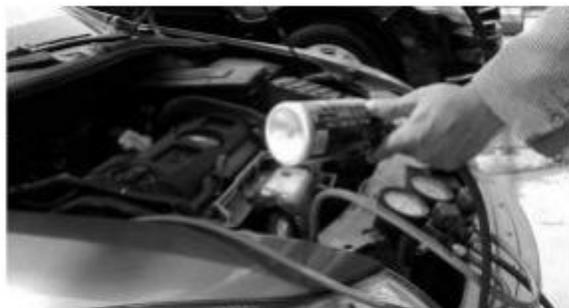
图 2-3-31 制冷剂的加注
