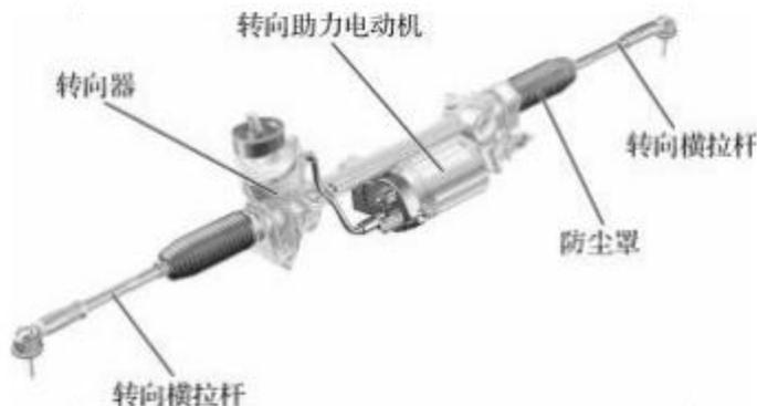
图 2-2-47 转向传动机构的结构
