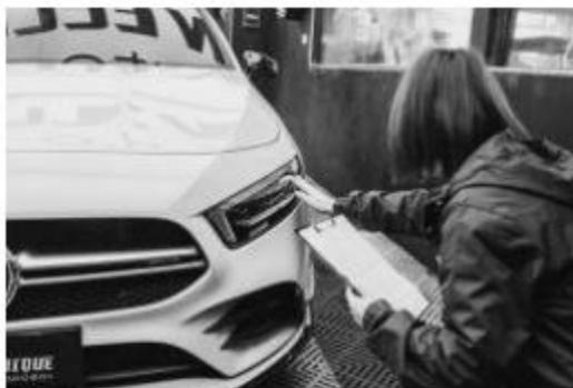
图 2-4-4 车辆漆面缺陷的目视检查
