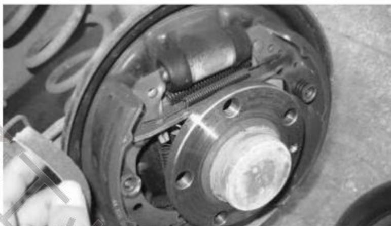
图 2-2-35 制动蹄片滑动区域的检查
