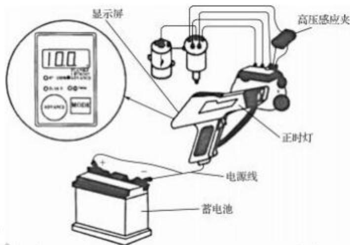
图 2-1-13 点火正时枪的连接
