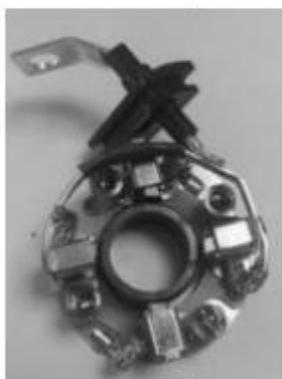
图 2-3-19 汽车起动机的电刷
