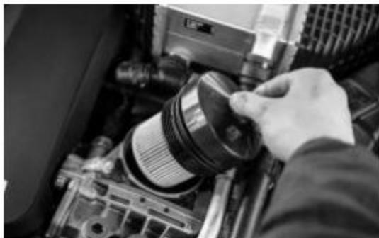
图 2-1-8 机油滤清器的更换
