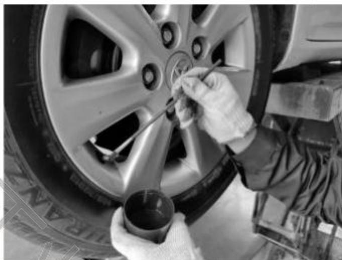
图 2-2-64 漏气的检测
