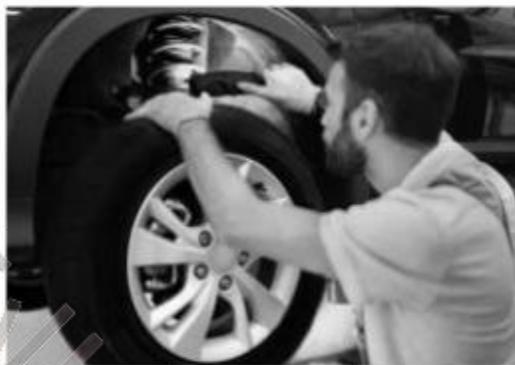
图 2-2-68 减振器的检查
