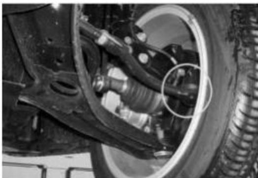
图 2-2-49 转向横拉杆的检查
