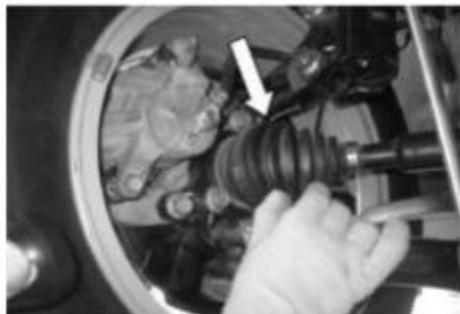
图 2-2-14 驱动轴外侧护套的检查
