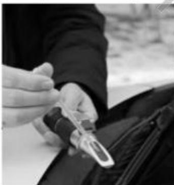
图 2-1-41 冷却液的检测
