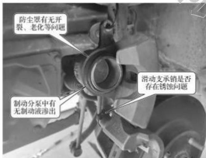
图 2-2-29 制动分泵的检查
