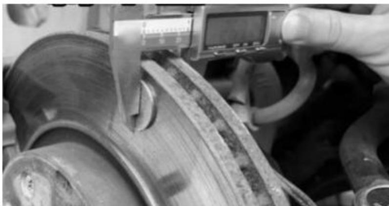
图 2-2-32 制动盘厚度的测量
