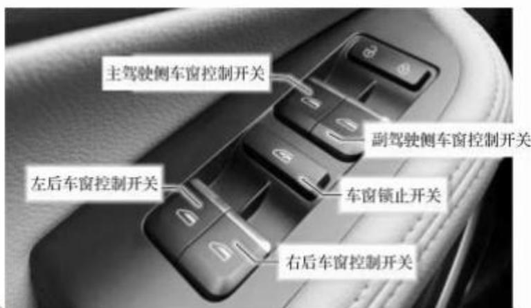
图 2-4-9 电动车窗的控制开关
