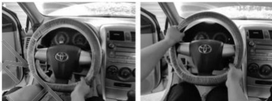
图 2-2-46 转向盘锁止机构的检查
