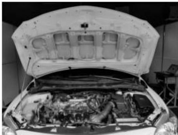
图 1-1-8 打开发动机舱盖
